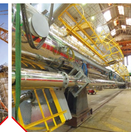
Production Equipement Sous-Pression : Colonne de plus de 42m de long et de 80t, élément-clé d'un projet sur le vapocraqueur.
