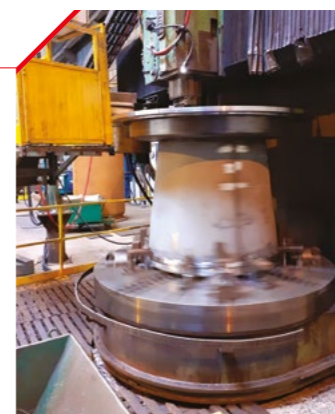
Mécano-soudure et usinage : Mécano-soudure et usinage tour vertical, de la modélisation jusqu'à la fabrication. Réalisation d'un cône d'entrée de broyeur en ABRAMAX 420 Cr pour une cimenterie. Dimensions Ø1700 x 1200 mm - Poids : 1.5T
