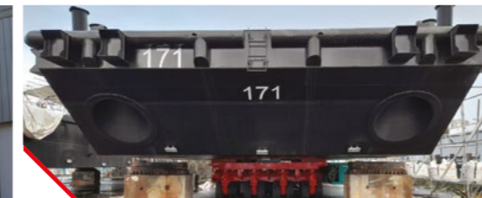
RAS de 30 mètres x 8 mètres : Réalisation carénage de deux ras portuaires en acier pour la Base Navale de Brest : reprise tolérances des RAS débordoirs après expertise des tôles (contrôle U.S.), la confection et la mise en place de bittes d'amarrages, de pitons à boucles, d'un parquet ainsi que le changement de BTH + échelles d'accès aux différents compartiments.
