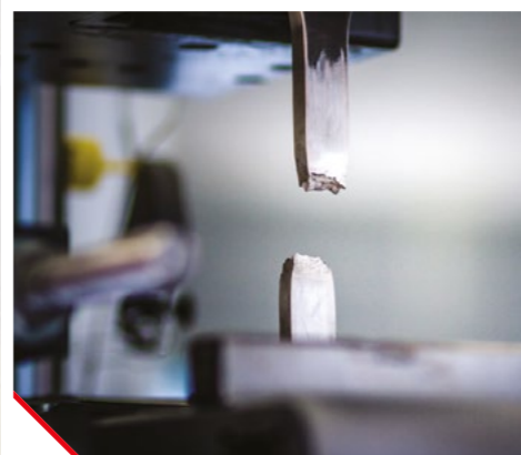
Laboratoire Essais Mécaniques Métallurgiques - Metrologie : Traction à température ambiante et traction à chaud jusqu'à 800°C.
